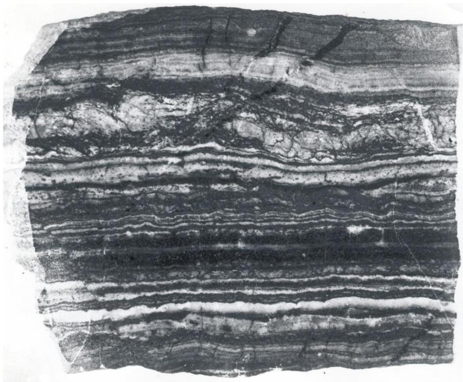
Рис. 3.8. Сетчатая структура замещения сидероплезита (светло-серое) магнетитом (черное). Железистый кварцит: м-ние Новокриворожское, карьер, полированный штуф. Нат. вел.
