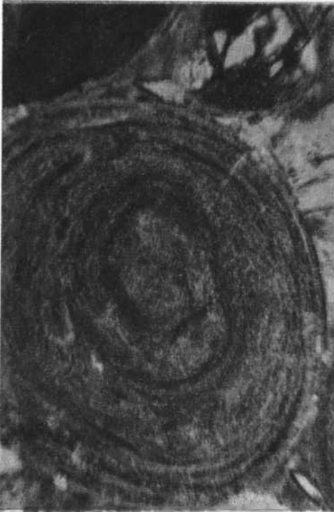
1. Хлоритово-гидрогетитовые оолиты с наружной хлоритовой оболочкой в сидеритовом цементе (Кок-булак, скв. 715). Увел. 150. 2. Гидрогетитовые оолиты первого типа в хлоритовой глине (Кок-булак; фашия переслаивания, скв. 696). Увел. 76. 3. Хлоритовый оолит, в отдельных концентрах частично окисленный (Кок-булак, скв. 716). Увел. 150. 4. Песчаная гидрогетитовая руда. Зерно полевого шпата замещено по трещинкам спайности гидрогетитом (Кок-булак, скв. 730). Увел. 150.
