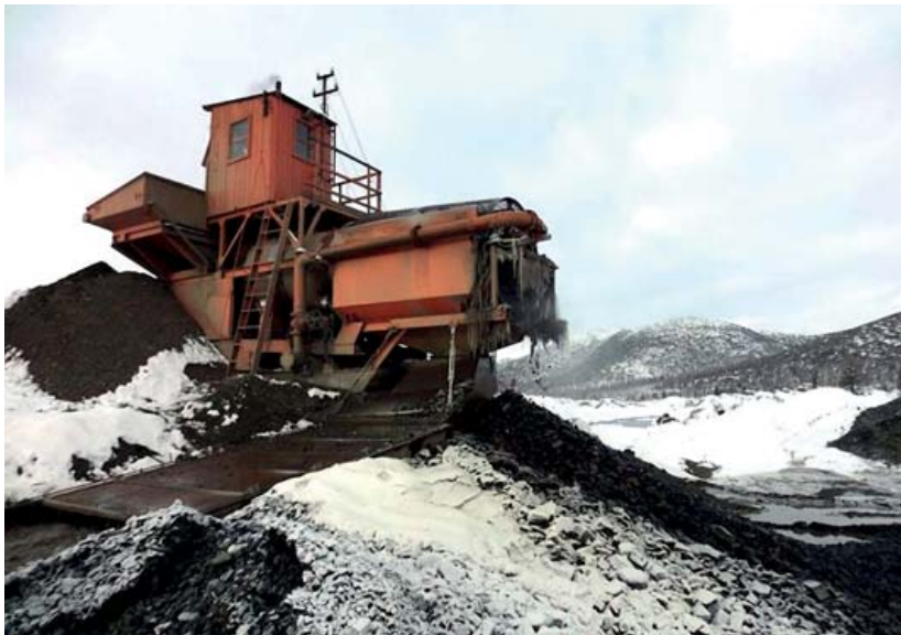
Промприбор ГДБ-100 в работе на россыпи в Магаданской области
