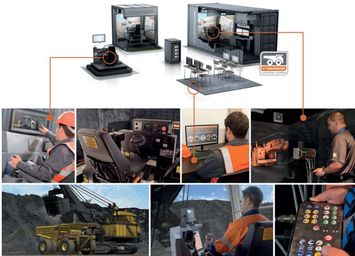
Многопрофильный учебно-тренировочный комплекс CYBERMINE в мобильном или стационарном исполнении для подготовки специалистов по эксплуатации оборудования для открытых или подземных горных работ
