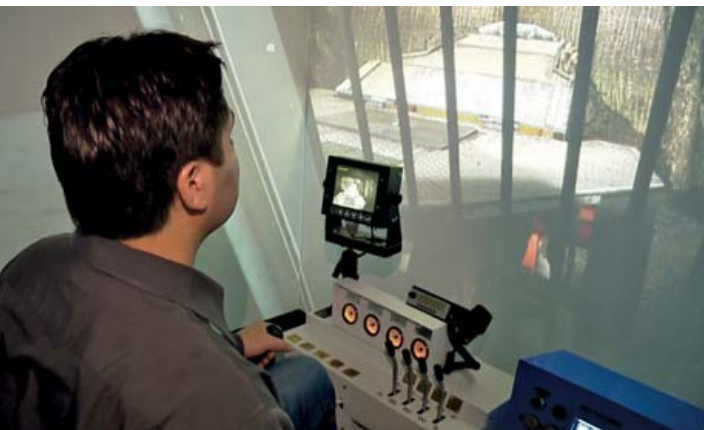
Тренажер-симулятор CYBERMINE для подготовки машинистов проходческих комбайнов избирательного действия Sandvik MH620 (Roadheader), разработанный на базе виртуальной копии подземного рудника «Интернациональный», Мирнинского ГОКА АК «АЛРОСА»
