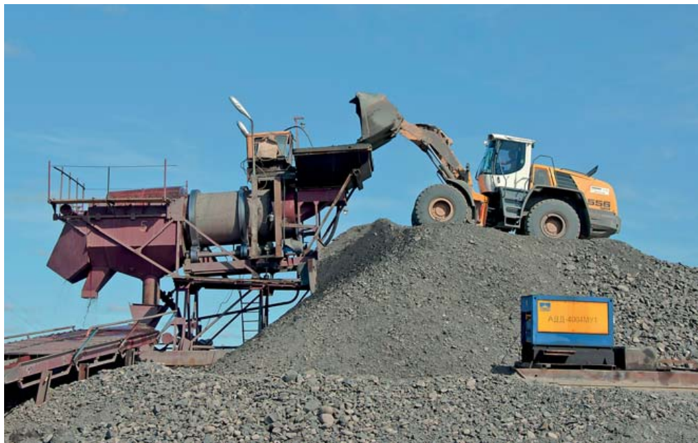
Бочечный промприбор на участке дочернего ООО «Астра»
