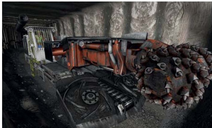
Тренажер-симулятор CYBERMINE для подготовки машинистов проходческих комбайнов избирательного действия Sandvik MH620 (Roadheader), разработанный на базе виртуальной копии подземного рудника «Интернациональный», Мирнинского ГОКА АК «АЛРОСА»
