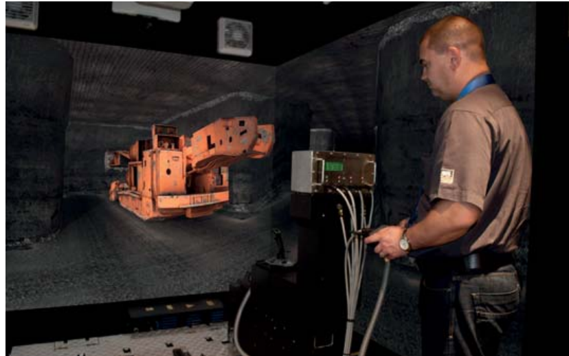
Тренажер-симулятор CYBERMINE для подготовки машинистов по управлению комбайнами непрерывного действия Joy Global CM12HM31-B
