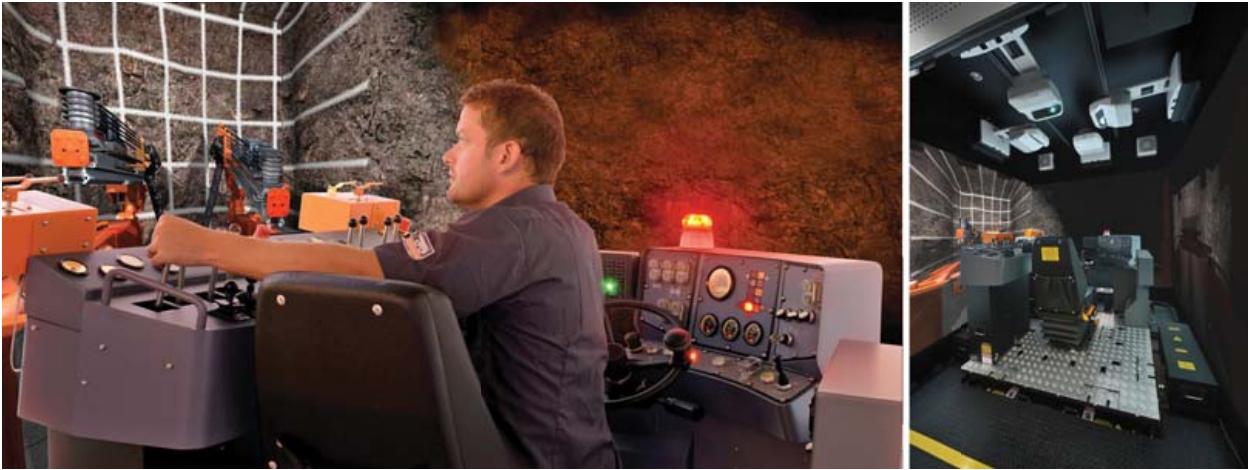
Тренажер-симулятор CYBERMINE для профессиональной подготовки операторов подземных двухстреловых буровых установок Sandvik DD420. При воссоздании рабочего места оператора, выполненного в виде съемного унифицированного модуля, используются только оригинальные приборы и органы управления
