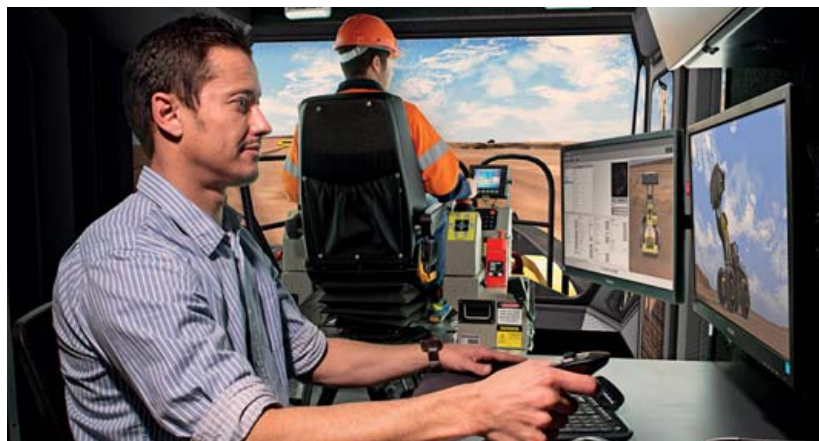
Учебно-тренировочный комплекс CYBERMINE 4-го поколения с динамической платформой с шестью степенями свободы для подготовки операторов по управлению оборудованием для открытых горных работ (на переднем плане — инструктор, на дальнем плане — стажер)
