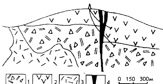
Рис. 4.102. Геологический разрез через зону Комсомольскую Юрьевского месторождения (по В. Г. Невструеву и Л. В. Эйришу (1981)).
