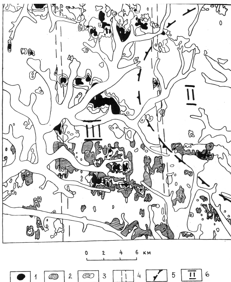
Рис. 2.8. Распределение главных золотоносных ассоциаций (по коэффициенту контрастности) во вторичных ореолах рассеяния западной части Кропоткинской купольной структуры (Перфильев и др., 1982).
