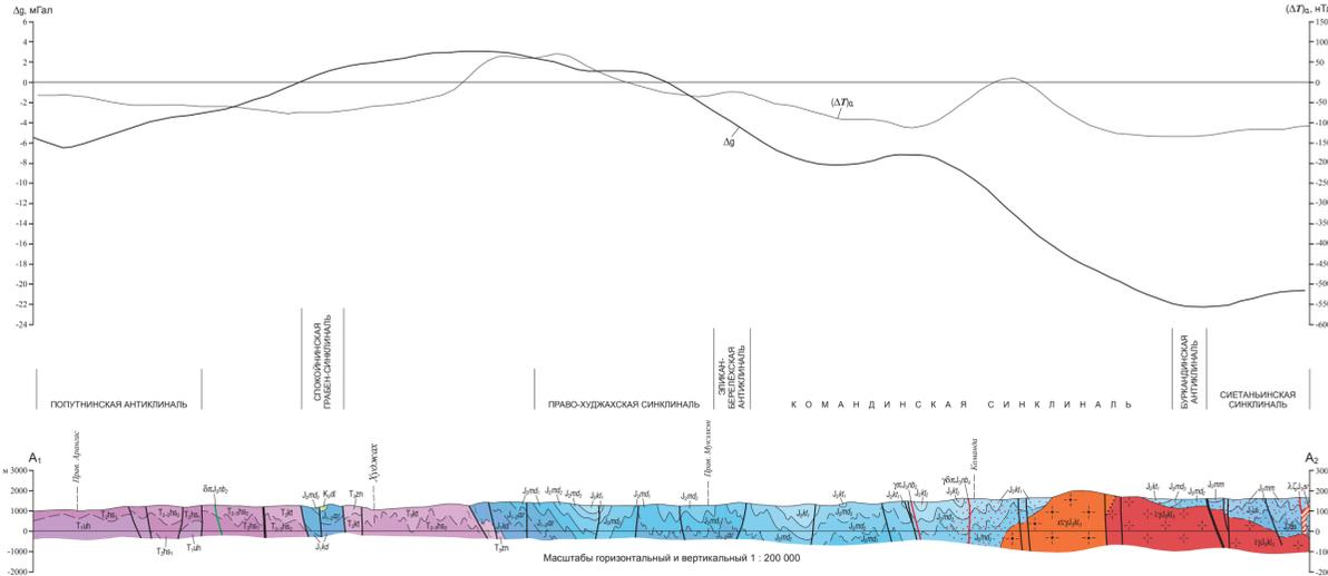
ГЕОЛОГИЧЕСКИЙ РАЗРЕЗ ПО ЛИНИИ Б<sub>1</sub>-Б<sub>2</sub>
