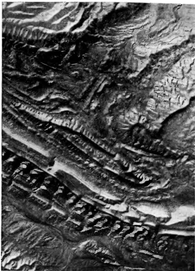
Рис. 27. Изображение на аэроснимке разрушенной антиклинали
