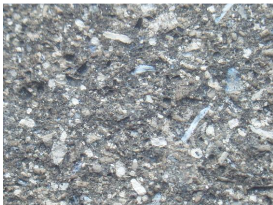
Рисунок 1. Цифровая фотография фосфатной фороды формации Навай Скв. LL-94, глуб. 67,70 м. Размер поля зрения 16 мм (слева). Дифрактограмма фосфатного песчаника (справа). Породообразующие минералы кварц и апатит (франколит).
