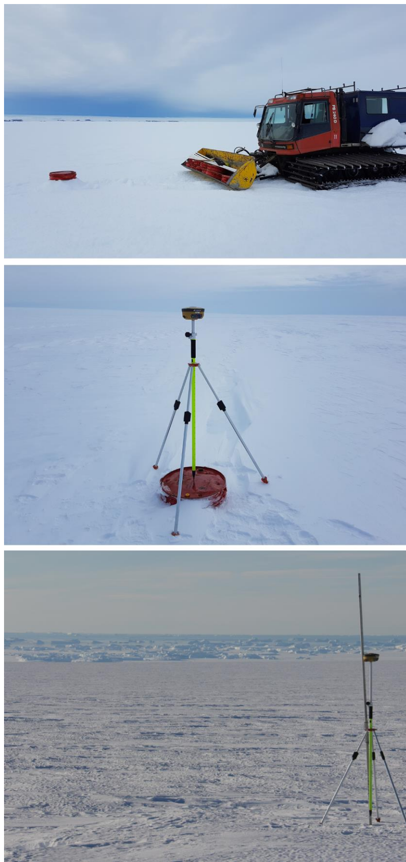
Рисунок 5.6 – Установка и определение координат маркированных точек на трассе СГП
