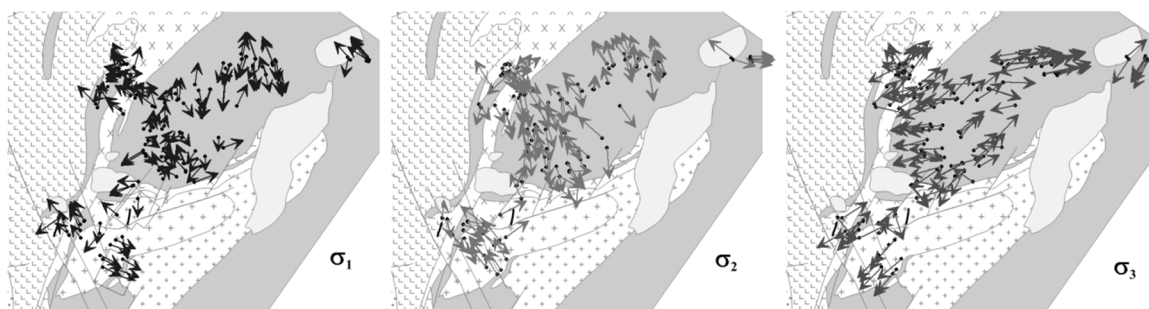
Рис. 3. Главная рудная фаза деформаций С: ориентация осей главных нормальных напряжений \sigma_1 , \sigma_2 и \sigma_3 локального ранга;
