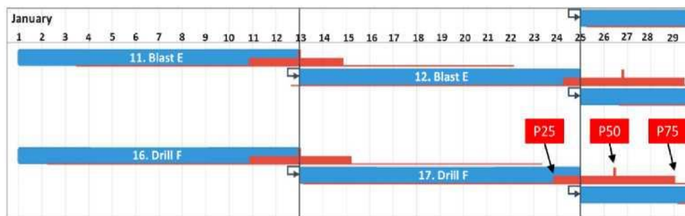
Рисунок 5-2. Пробуксовка при проведении взрывных работ
