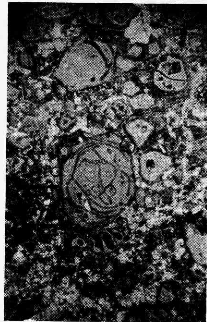
Рис. 14. Начальные стадии превращения пород с перлитовой отдельностью в кластические породы в результате выветривания и дезинтеграции
