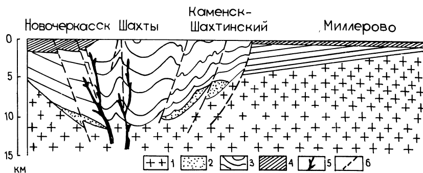
Рис. 8. Схематический геологический разрез (профиль) через Донецкий каменноугольный бассейн. Условные знаки: 1 — древние кристаллические породы (фундамент); 2 — девон; 3 — каменноугольная угленосная толща; 4 — молодые отложения (меловые и третичные), перекрывающие угленосную толщу; 5 — изверженные (магматические) породы; 6 — разрывы земной коры (сбросы и надвиги)
