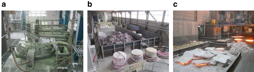
Abb. 9.12 Hauptarbeitsschritte für die Herstellung von synthetischen Korund-Körnungen: (a) Schmelzen der \text{Al}_2\text{O}_3 -Rohstoffe in Lichtbogenöfen bei 2000–2100 °C; (b) Abgießen in Blöcken und Abkühlung; (c) Grobzerkleinerung mit Hydraulikhämmern. (Quelle: Imerys Fused Minerals, Zschornowitz GmbH, mit freundlicher Genehmigung)
