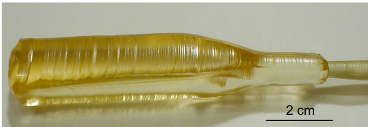
Abb. 8.9 Synthetischer piezoelektrischer Einkristall von SNGS ( \text{Sr}_3\text{NbGa}_3\text{Si}_2\text{O}_{14} ), gezüchtet aus der Schmelze mittels Czochralski-Verfahren
