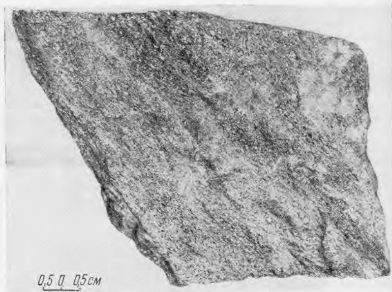
Фиг. 2. Пластиначный агрегат троилита. Светло-серые сферолиты — антофиллит. Штуф.
