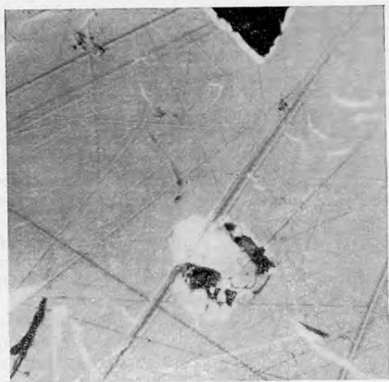
Фиг. 9. Более поздние включения креннерита (белое) в тонкозернистом агрегате петцита — гессита. Петцит и гессит на фото неразличимы. \times 750 , в иммерсии, в белом свете. Месторождение Калгурли.
