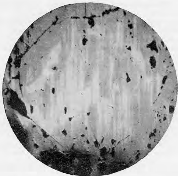
Фиг. 4. Тонкие полисинтетические двойники цинккениита. Шлиф полированный, \times 400 , в имерсии, без анализатора.
