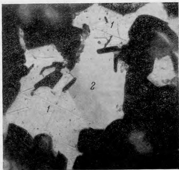
Фиг. 10. Сrostок алтаита 1 и калаверита 2 с включениями чешуек хлорита (черные таблички) в кварце. R_1 > R_2 . \times 750 , в иммерсии, в белом свете. Месторождение Калгурли.
