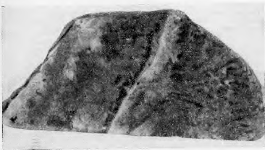
Фиг. 1. Прожилки сфалерита с кварцем и пиритом в кварц-цинкенитовых образованиях. Штурф полированный. \times 6 .
