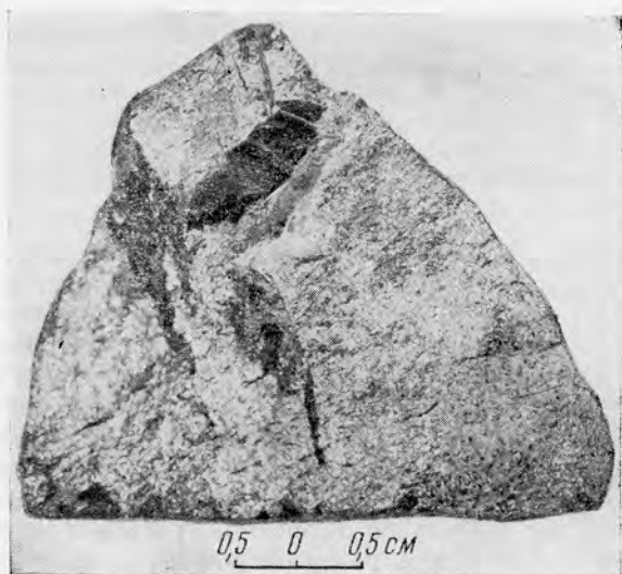
Фиг. 4. Крупный кристалл сильно магнитного пирротина в тонкозернистом агрегате мелких изометричных зерен парамагнитного пирротина. Штуф.
