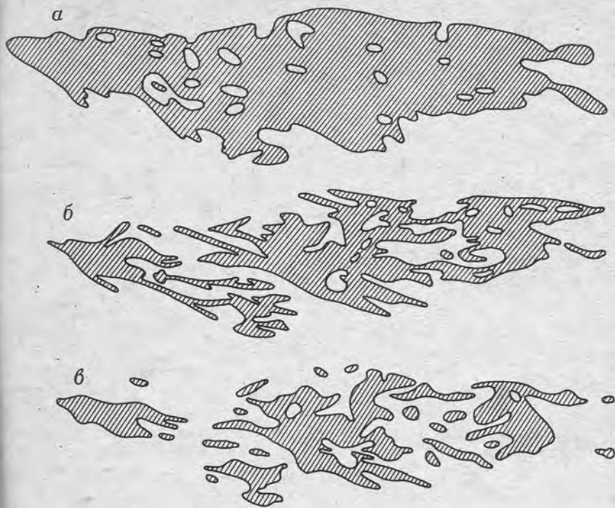
Рис. 2. Изменение морфологии рудной залежи в зависимости от бортового содержания (в усл. ед.): а — 0,01, б — 0,03, в — 0,1
