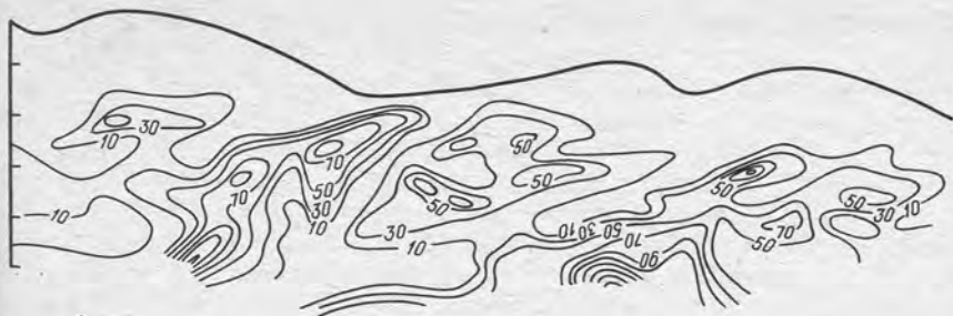
Рис. 8. Положение рудных столбов, фиксирующееся по изолиниям метропроцентов (в усл. ед.) в проекции на вертикальную плоскость жильной зоны
