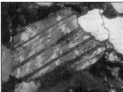
Рис. 7.13. «Шахматная» альбитизация обломочного плагиоклаза в ушницкой свите. Шлиф, ник. +, увел. 200. По А.В. Копелиовичу (1962).
