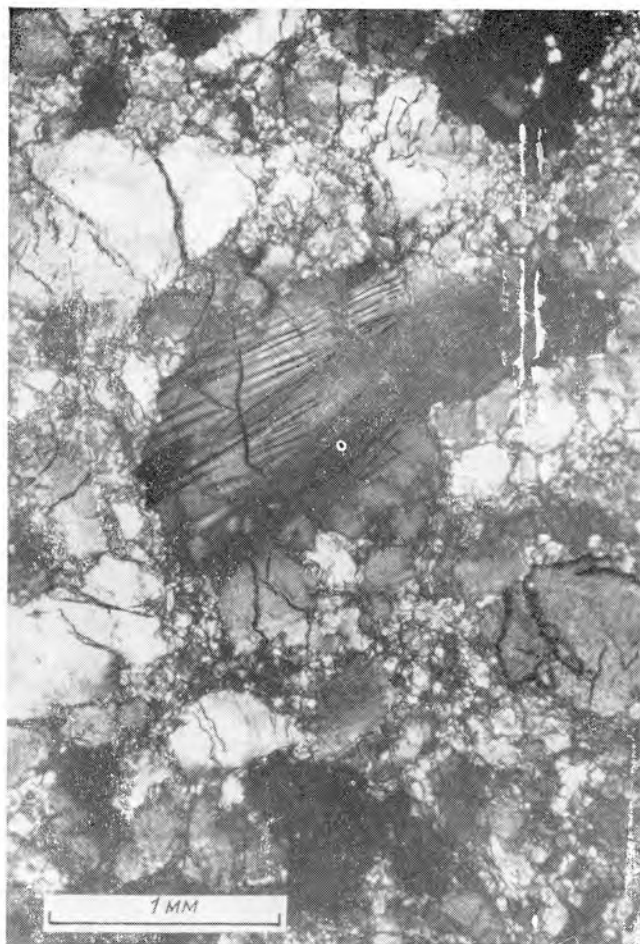
Фото 2. «Узкие» полосы сброса в зерне оливины из обр. 609-1А (сечение ориентировано под острым углом к плоскости их границ). Хорошо видна косая ( 17^\circ ) ориентировка границ узких полос по отношению к границе более широкой полосы в правой части зерна (поставлена на погасание), а также изгибы границ некоторых «узких» полос сброса. На стыках зерен видны мелкие рекристаллизованные зерна оливины. Николи. +.
