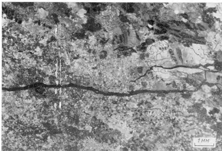
Фото. 3. Синметаморфическая рекристаллизация оливина в полосе шириной около 3 см. Видна периферическая часть полосы. Справа сверху протогранулярный дунит, слабо затронутый рекристаллизацией. В нижней части снимка хорошо заметны контуры старых зерен, «просвечивающие» благодаря близкой ориентировке новообразованных зерен. Обр. 364-3. Ув. 14. Николи +.
