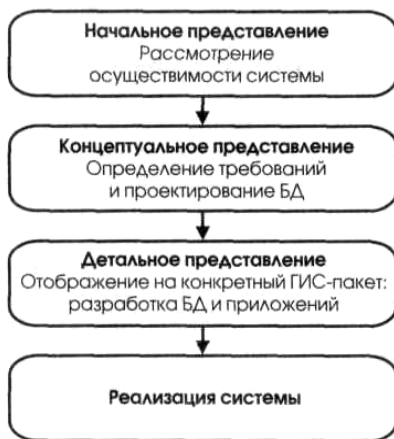
Рис.21. Модель проектирования ГИС
