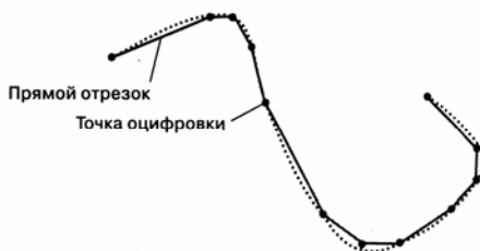
Рис.7. Оцифровка сложной линии
