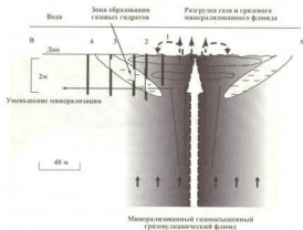
Рис. 5.7. Предполагаемая схема разгрузки флюида в районе грязевого вулкана «Маленький» (Т.В. Погадаева, Т.И. Земская, И.Н. Доля, О.М. Хлыстов, Т.В. Ходяков, 2005)
