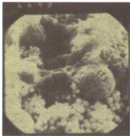
Рис. 8.14. Опокovidный силицит. Пиленигская свита (Сахалин). Фотография с помощью сканирующего электронного микроскопа. Увеличение \times 3000 раз. Шарообразные выделения – глобулы кристобалита (А.И. Юрочко, 1981)
