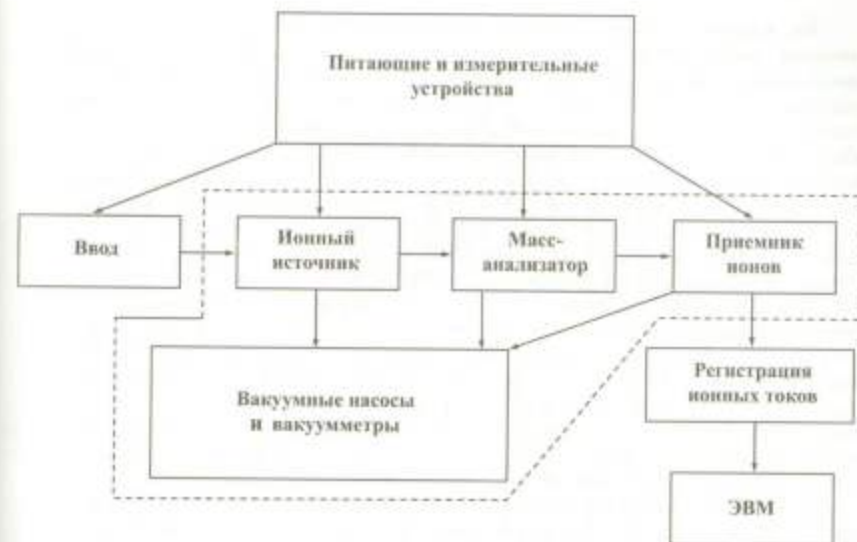
Рис. 6.7. Блок-схема масс-спектрометра (пунктиром обозначена вакуумированная часть прибора)
