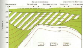
Рис. 5.6. Профиль зоны гидратообразования в Центральной Якутии с учетом давления, состава газов и минерализации пластовых вод (А.А. Трофимчук, Ю.Ф. Макогон и М.В. Толкачев, 1981).
