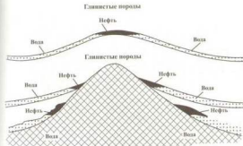
Рис. 12.12. Схема ловушки, связанной с погребенным выступом рельефа (по У. Расселу)
