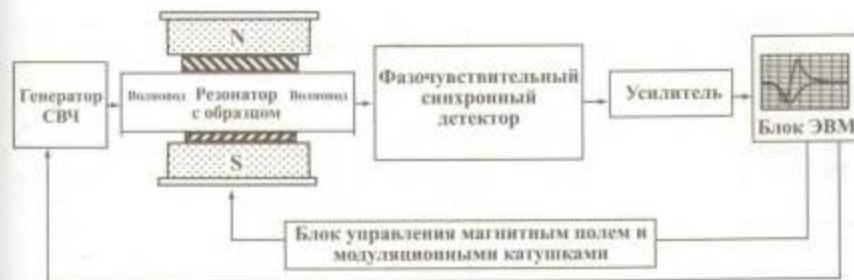
Рис. 6.24. Упрощенная блок-схема установки для наблюдения электронного парамагнитного резонанса
