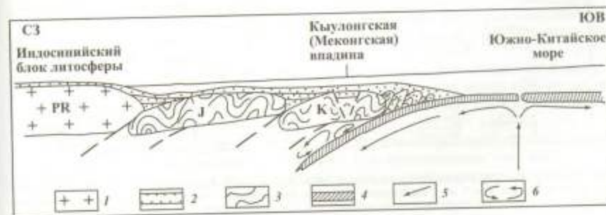
Рис. 7.7. Концептуальный геологический профиль через южный шельф Вьетнама (В.П. Гаврилов): 1 – древний фундамент; 2 – осадочный чехол; 3 – молодой складчатый фундамент; 4 – океаническая литосфера; 5 – направление движения мантийного вещества; 6 – задуговая конвекция
