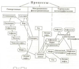
Рис. 4.38. Схема образования нафтидов различных генетических линий Ю.К. Баженова и др., 2004г.
