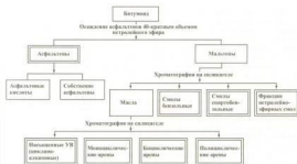
Рис. 3.19. Схема определения группового состава битумоидов
