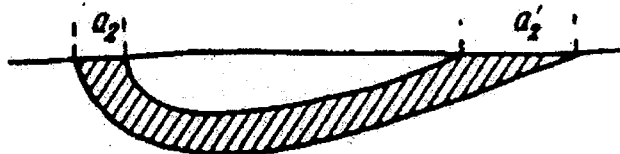
Рис. 10.14. Зависимость ширины выхода пласта на дневную поверхность от угла его падения [Сапфиров, 1965]
