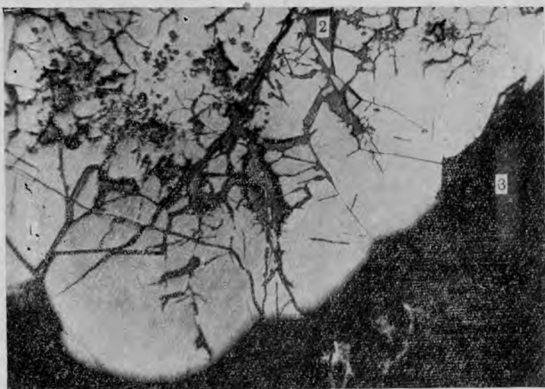
Рис. 71. Крупные почки урановой смолки разрезаются кальцитом (полированный шлиф; \times 85 ): 1 — урановая смолка; 2 — кальцит; 3 — жильные минералы.
