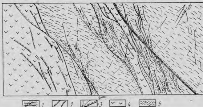
Рис. 52. Строение рудной зоны, приуроченной к контакту дайки диабазов (разрез):
