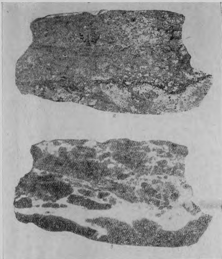
Рис. 54. Брекчиевидная текстура рудного прожилка: a — фотография штуфа (натуральная величина); б — радиография того же штуфа (экспозиция 16 ч).
