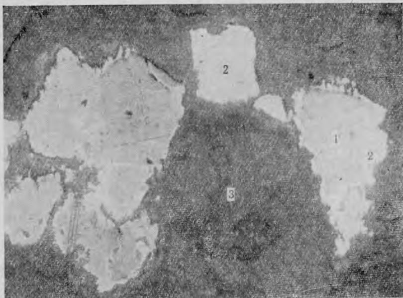
Рис. 65. Сфалерит корродируется и замещается галенитом (полированный шлиф; \times 165 ):
