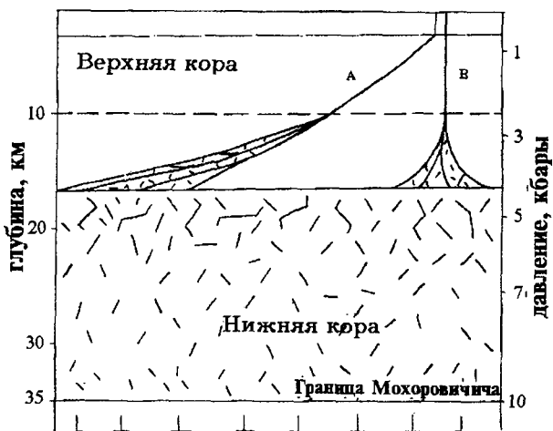
Рис. 6.8. Листрические разломы (А), появляющиеся из-за переориентации главного сжатия от вертикали к горизонтали с ростом глубины (В = вертикальный разлом в зонах растяжения коры)
