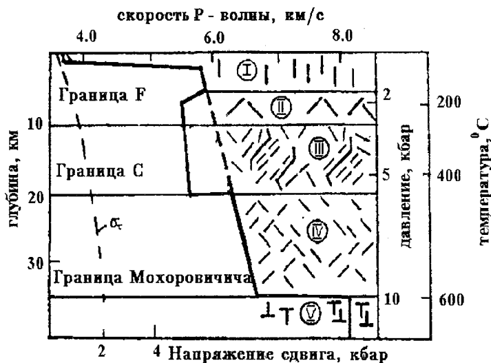
Рис. 6.6. Строение земной коры с границами F, C, M - Форша, Конрада и Мохоровичича (пунктир соответствует сплошным состояниям пород; точками дана линия напряжений сдвига, требуемых для тектонического разрушения пород) [90]
