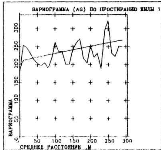
Рис.4.9. Пример подбора двухструктурной сферической модели вариограммы с помощью процесса VARFIT
