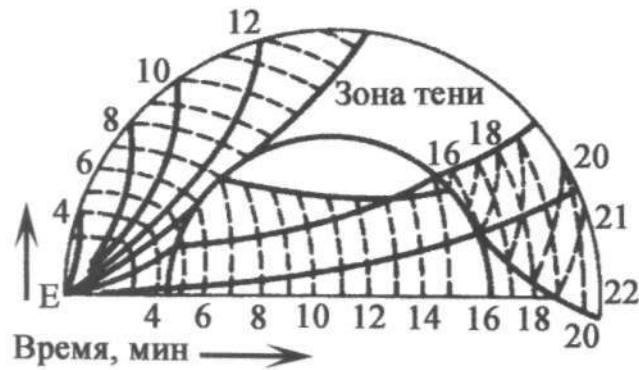
Рис. 2. Распространение продольных сейсмических волн (Р-волн) в недрах Земли (по В.Н. Жаркову).
