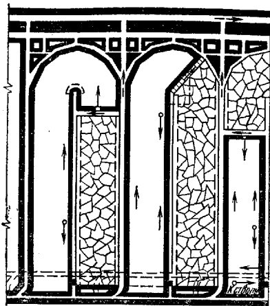
Рис. 23.22. Технологические схемы разворота очистного комплекса при переводе его из отработанной лавы в новую
