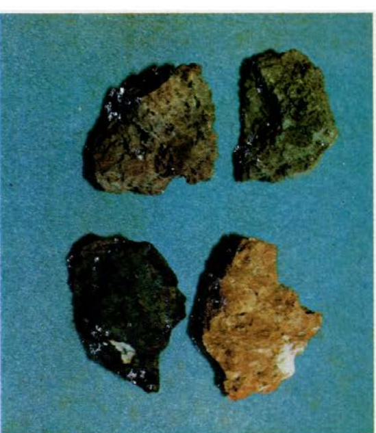
Стадии обжиги сопочной брекчии. Слева вверху — исходная серая сопочная брекчия; справа внизу — черная шлаковидная брекчия (конечный продукт обжиги)
