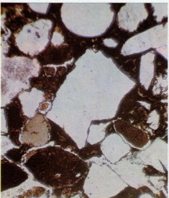
Песчанник оруденелый с оолитами и псевдооолитами хлоритового состава. Ачинское рудопроявление. Никольи ||
