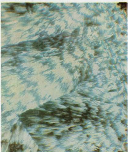
Радиально-лучистые агрегаты лоннебургита в железной руде Новоселовского месторождения. Николи +
