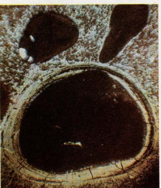
Оолиты и псевдооолиты в базальном хлоритовом цементе, частично замещающиеся сидеритом. Новоселовское месторождение. Николи ||
