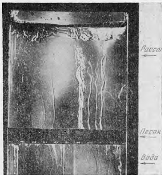
Рис. 6. Фотография опыта, в котором слой рассола в верхней части сосуда отделен слоем песка от расположенной под ним воды
