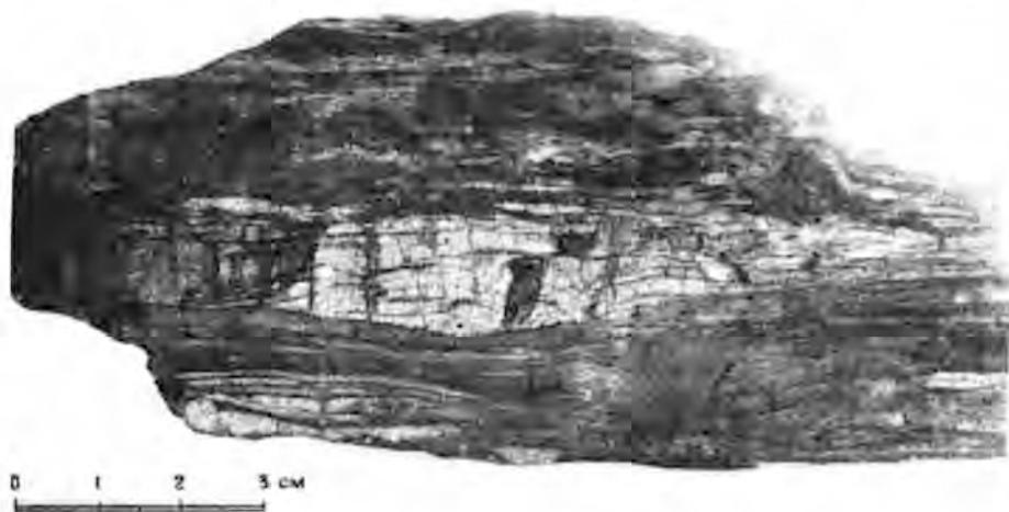
Рис. 31. Поперечные трещины растяжения в прослое песчаника внутри алевролитов (валанжин). Левый борт долины р. Тарги, недалеко от ее устья (колл. автора)
