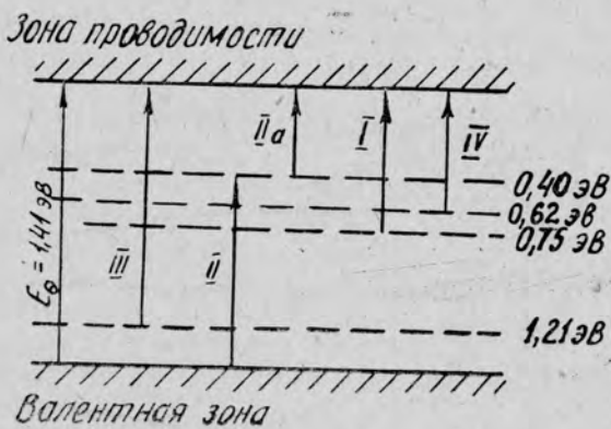
Рис. 4. Схема расположения примесных уровней и переходом в InP, компенсированном хромом.
