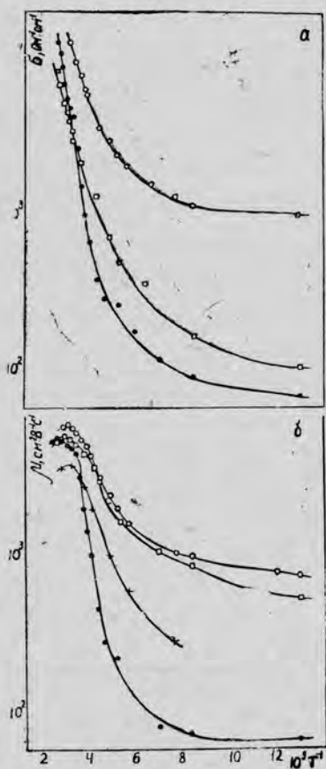
Рис. 3. Температурная зависимость a — электропроводности, b — подвижности носителей; \square — стеклянные подложки, \circ — ферритовая подложка, + — температурные данные [2].
