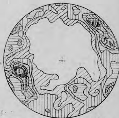
Рис. 2. Круговая диаграмма трещиноватости юрских-меловых отложений Большебалханской антиклинали в изолиниях (470 замеров). Количество замеров в %: 1 — более 15; 2—15—12,5; 3—12,5—10; 4—10—7,5; 5—7,5; 6—5—2,5; 7—2,5—0.
