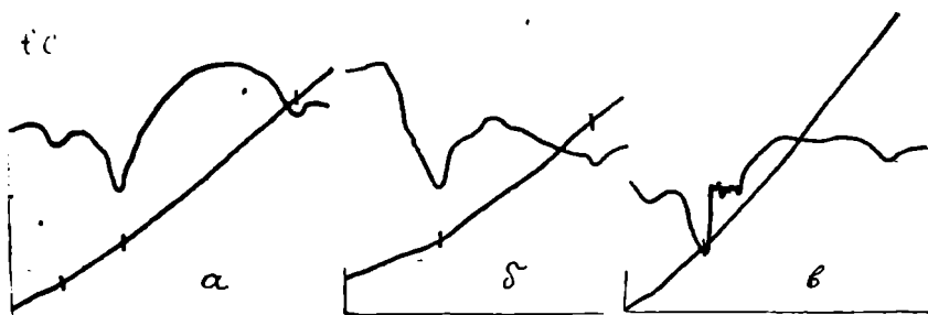
Рис. 2. Термограммы солей. а— \text{KРb}(\text{NO}_2)_3 \cdot \text{CH}_3\text{COCH}_3 ; б— \text{K}_2\text{Рb}(\text{NO}_2)_4 ; в— \text{K}_4\text{Рb}(\text{NO}_2)_6 .
