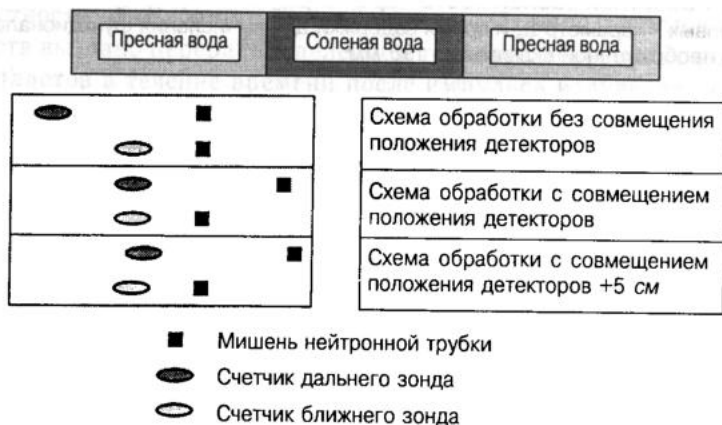
Рис. 6. Расчетные диаграммы водородосодержания, вычисленного по палетке для мощного однородного пласта с пресным заполнением пор по данным зондов 27 и 57 см при задержке 512 мкс и разных способах совмещения показаний
