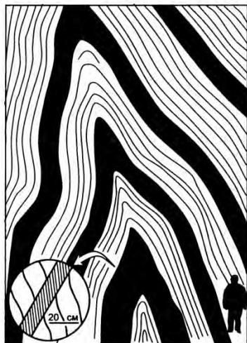
Рис. 7.41. Преломление кливажа на крыле килевидной антиклинальной складки, нерундинская свита (рифей?), Уаикитская зона, Северное Забайкалье (рисунок по фотографии): тонкий проникающий кливаж осевой плоскости в алевролитах и более редкий прямой веер в песчаниках.
