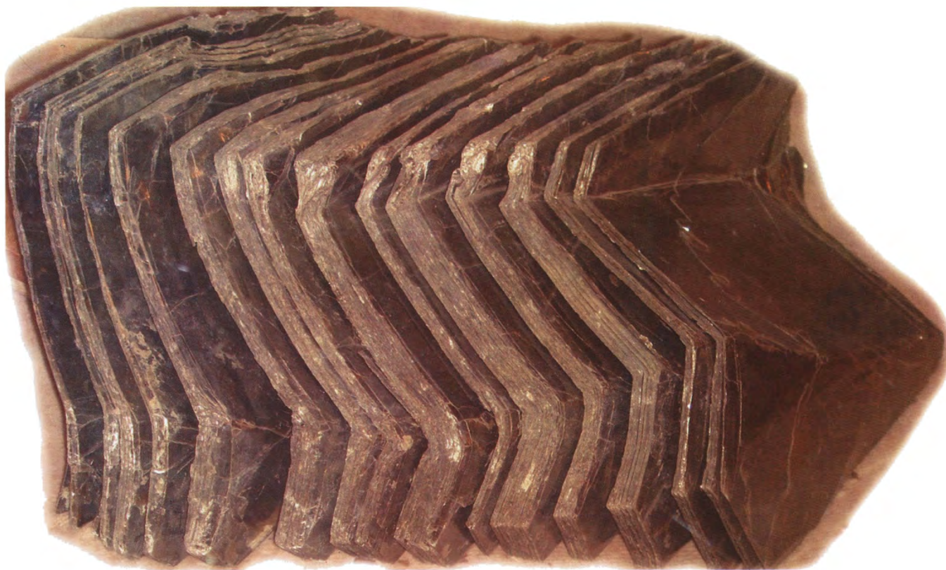
Фиг. 6.2. Кинкбанд в мегакристалле флогопита, расколотом по плоскостям спайности (в натуральную величину).
