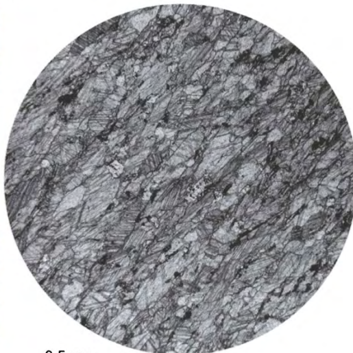
Фиг. 5.1. Сланцеватость, образованная планпараллельным расположением кристаллов биотита ( a ) и доломита ( б ). Слева – гнейсы беломорского комплекса (фото В. Травина), справа – карбонатный сланец, Келяно-Иракиндинская зона, Северное Забайкалье. Микрофотографии шлифов, +.
