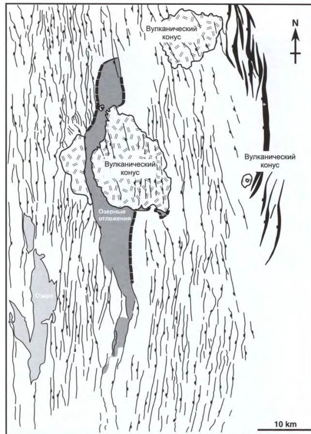
Фиг. 8.6. Система рифтовых разломов: рифт Грегори, Восточно-Африканская рифтовая система, на космоснимке Landsat TM (а) и интерпретационной схеме (б). Сбросы вдоль восточной границы рифта сегментированы и слегка смещены друг относительно друга, отмечается высокая плотность субмеридиональных внутририфтовых разломов. Такой структурный рисунок сбросов является характерным для собственно рифтовых структур, без существенной сдвиговой составляющей раскрытия, в обстановке растяжения (в данном случае субширотного) [McClay et al., 2002].
