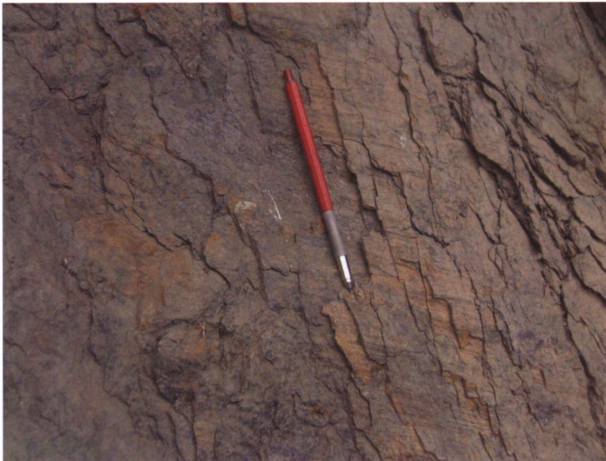
Фиг. 8.5. Штриховка скольжения и сколовые ступеньки на поверхности сколовой трещины в меловых алевролитах, зона Кулишовского разлома, Приморье.
