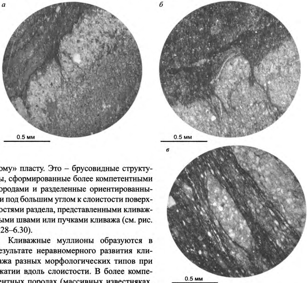
Рис. 6.32. Стадийность образования микромуллионов в алевролитах мухтунной свиты (верхний рифей), Уакитская зона, Северное Забайкалье: а – формирование пучков кливажа, б – зарождение муллионов, в – полное обособление более компетентного прослоя (микрофотографии шлифов).
