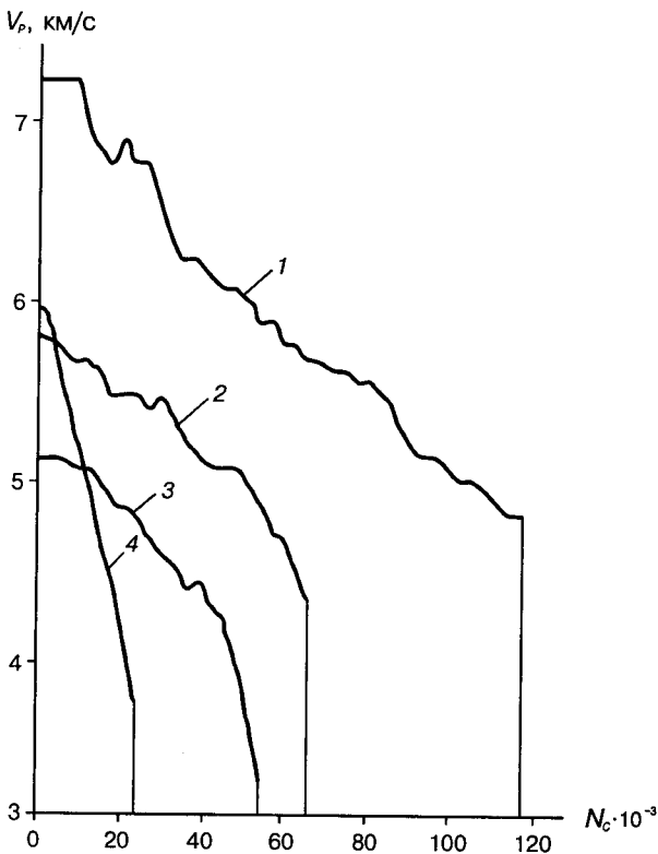
Рис. 9.3. Изменение скорости распространения продольных колебаний в образцах керна в зависимости от числа циклов нагружения: 1–4 — испытываемые образцы
