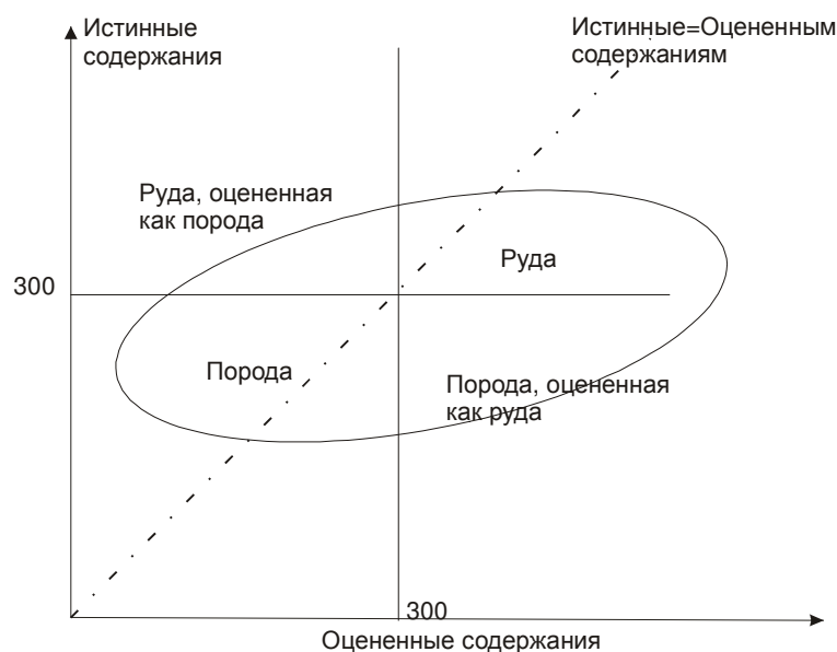
Рисунок 6.11. Диаграмма разброса истинных значений против оценочных. Облако точек ограничено эллипсом. Блоки с оцененным значением больше 300 намечены для добычи, в то время как могут быть добыты только блоки с действительным содержанием больше 300.
