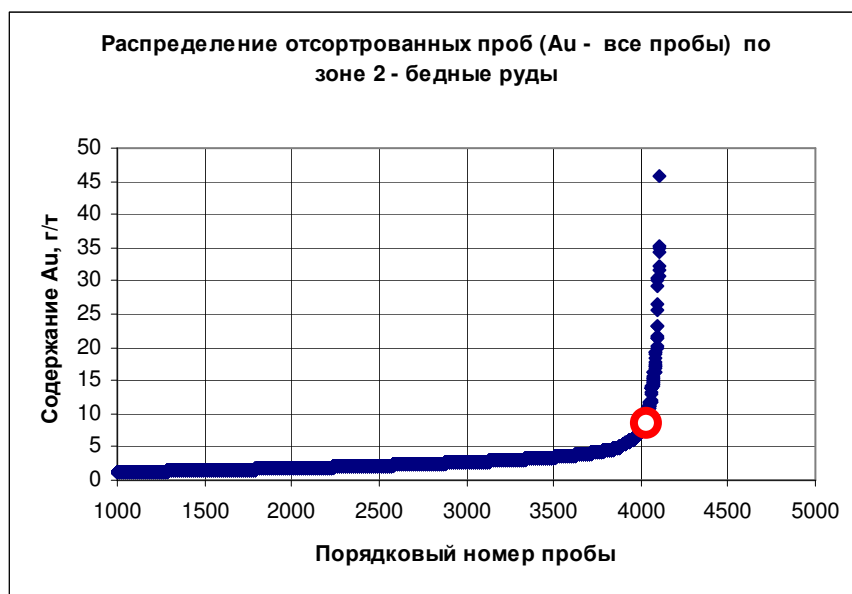
Рисунок 3.9. Определение границы «ураганов» по месту излома графика ранжированных по возрастанию значений проб.
