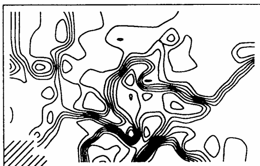
Рисунок 5.12. Изолинии, полученные для точечного кригинга с использованием только трех ближайших проб
