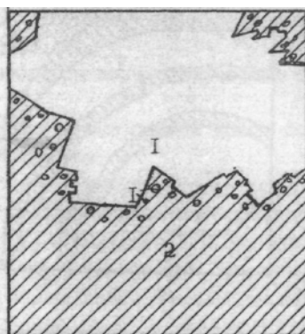
Рис.27. Пойкилитовая и гипидиоморфнозернистая структура сростания галенита и кальцита. Мелкие выделения галенита (1) захватываются при росте относительно идиоморфных кристаллов кальцита (2). Рисунок по фотографии. Полированный шлиф, ув. 400, ник. П.
