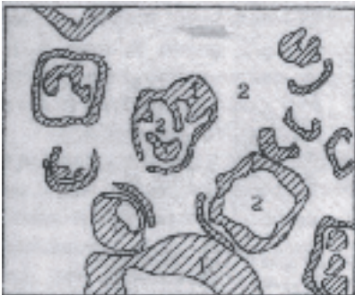
Рис. 34. Скелетная коррозионная структура. Замещение центральных частей кристаллов магнетита(1) карбонатом (2). Полированный шлиф, ув. 410. По А.Г.Бетехтину, 1958г.
