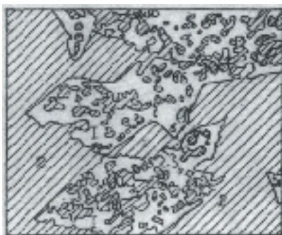
Рис.36. Метакристаллы арсенопирита (1), переполненные включениями нерудных минералов (серпентин и др.), слагающих основную массу. Полированный шлиф,ув.40.По А.Г.Бетехтину,1958г.
