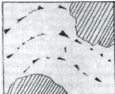
Рис.45. Структура смятия. Пластическая деформация галенита(1) заметна благодаря изгибам трещинок спайности, трассируемых треугольниками выкрашивания. Полированный шлиф,ув.40
