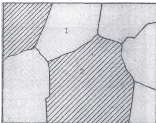
Рис.25. Аллотриоморфнозернистая структура срастания пирита(1) и арсенопирита(2). Рисунок по фотографии. Полированный шлиф, ув.200, ник.П
