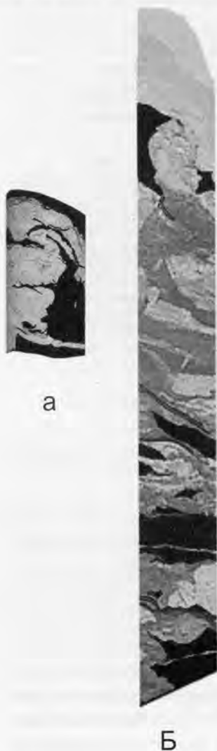
Рис. 22. Фотографии кернов перемятых пород баженской свиты в Восточно-Сургутской зоне «аномальных» разрезов (по А.П. Соколовскому и Р.А. Соколовскому, 2002 [90]).
