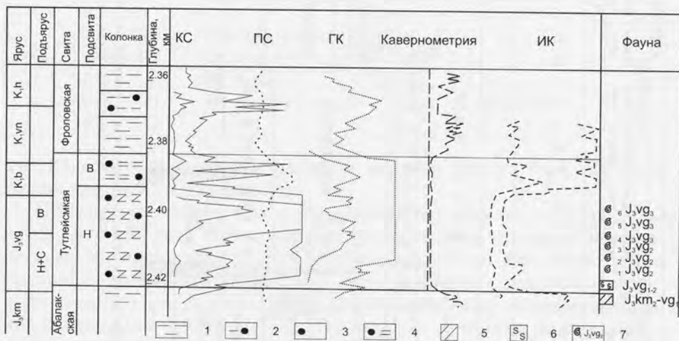
Рис. 33. Красноленинский тип разреза битуминозных отложений. Составил Ю.В. Брадучан, 1984 г.
