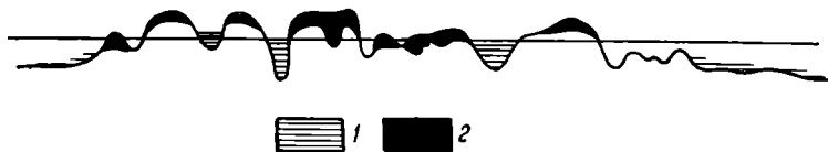
Рис. 19. Залегание огнеупорных глин (1) и бокситов (2) Ленинградской области в зависимости от геоморфологических условий, унаследованных от девонского периода (по А. П. Волкову)
