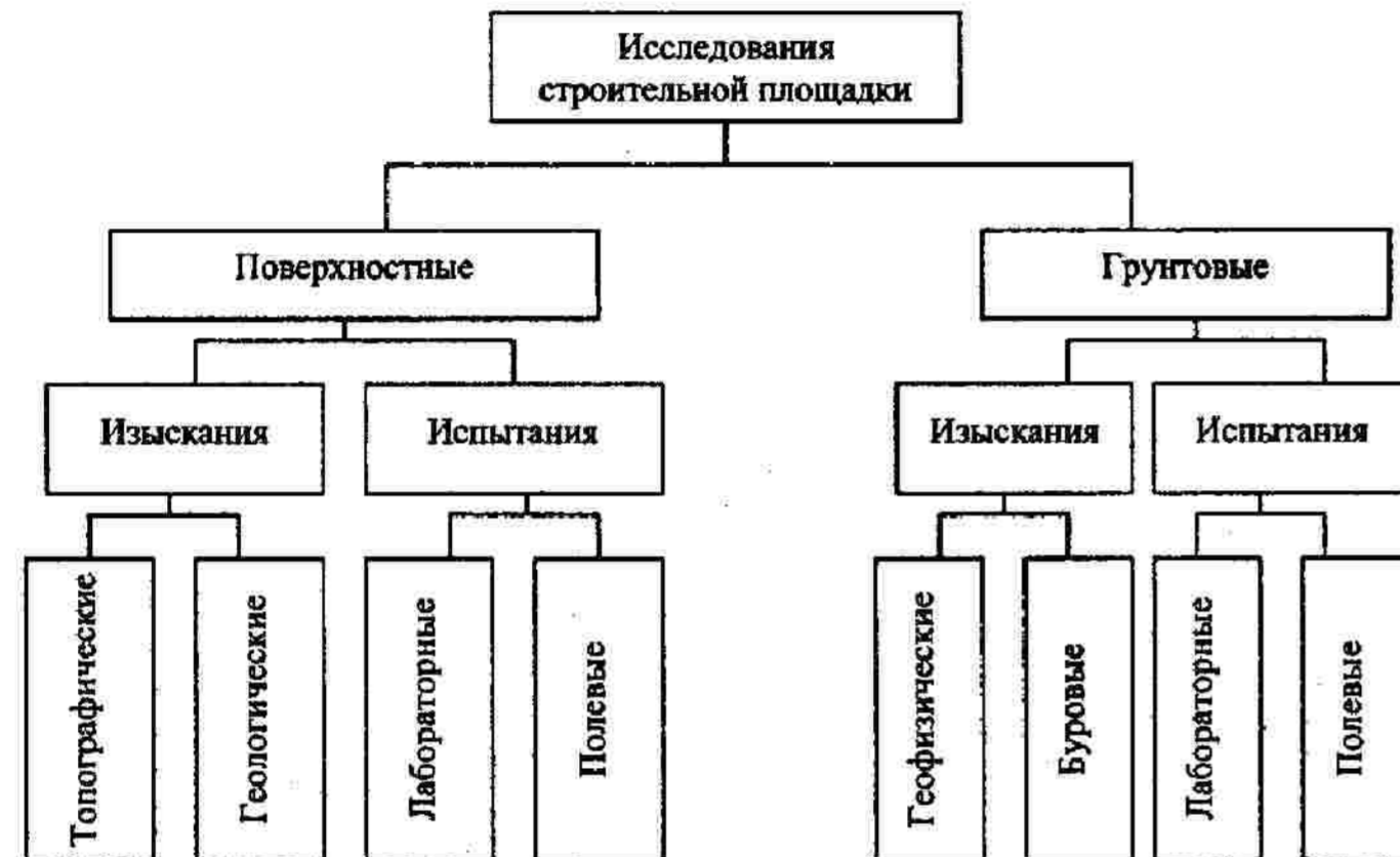
Рис. 1.9. Схема видов работ, выполняемых при инженерно-геологических изысканиях
