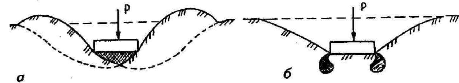
Рис. 6.13. Схемы расчетных моделей, схематизирующих зависимость между осадкой и нагрузкой на грунт:
