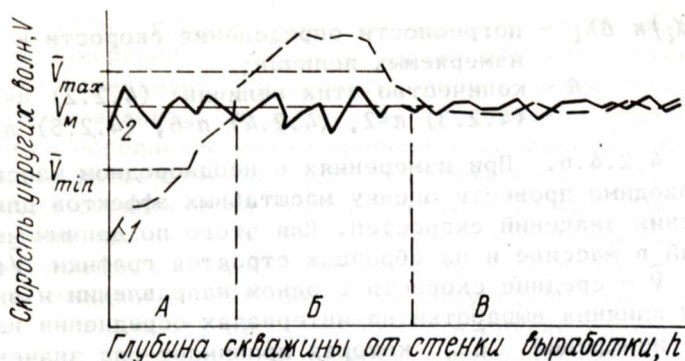
Рис. 20. Виды распределений скоростей упругих волн вблизи выработки:
