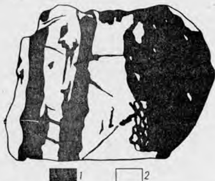
Рис. 15. Текстура рудных образований на уровне строения штупа. Прожилки сфалерита и галенита (1) в жильной сидеритовой массе (2). Полированный штуп, \frac{3}{4} натуральной величины. (По данным В. Борнхардта из книги А. Г. Бетехтина)
