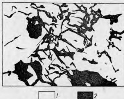
Рис. 16. Структура медной руды на уровне строения шлифа. Катакластическая структура кварца (1), сцементированного халькопиритом (2). (По данным А. Г. Бетехтина). Полированный шлиф, \times 46
