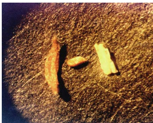
Рис. 2.2.2. Частицы кварца, покрытые окисленными пленками (от 28 мкм до 1 мм) (бинокуляр, увел. 50 x )
