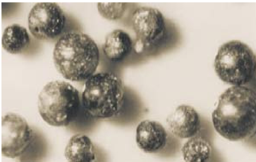
Рис. 4.3.5.1. Магнетитовые микрошарики под микроскопом (отражённый свет) (Кизильштейн и др., 1995)
