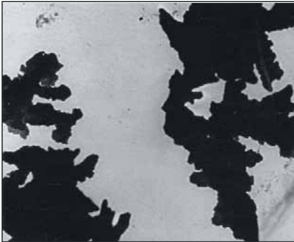
Рис. 2.2.33. Дендритовые кристаллы тодорокита из агрегата твердого осадка снега в просвечивающем электронном микроскопе и его МДК (увел. 1500 x )
