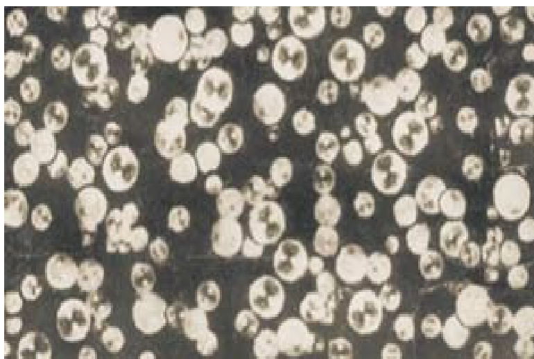
Рис. 4.3.4.1. Алюмосиликатные полые микросферы под микроскопом (отражённый свет) (Кизильштейн и др., 1995)
