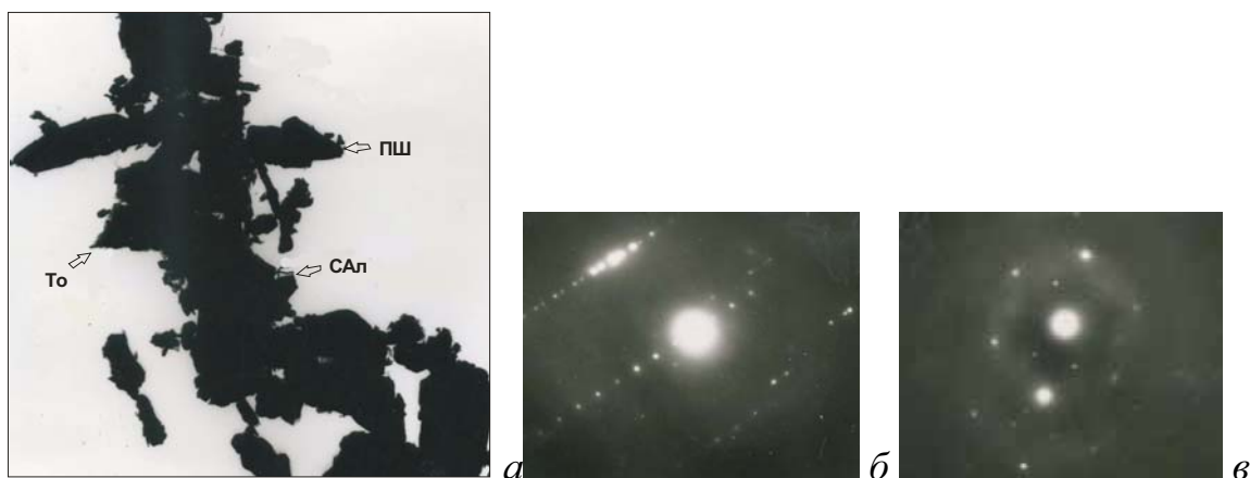
Рис. 3.2.24. Агрегат частиц слоистого алюмосиликата (САл), полевого шпата (ПШ) и призматического кристалла тодорокита (То) почвы в просвечивающем электронном микроскопе (увел. 600 x ) (а); МДК полевого шпата (б); МДК тодорокита (в)
