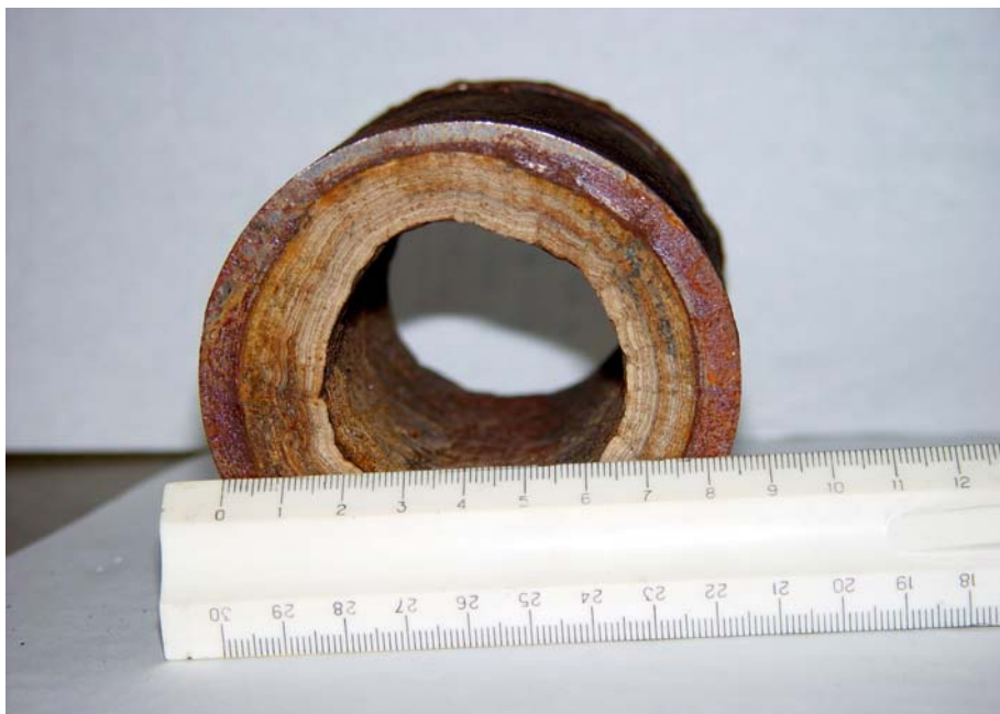
Рис. 6.2.1. Насосно-компрессорная труба с комплексными отложениями солей
