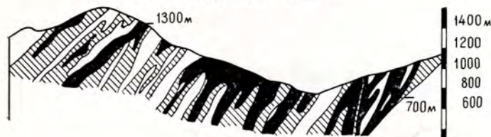
Схема распределения концентраций золота в плоскости рудной зоны
