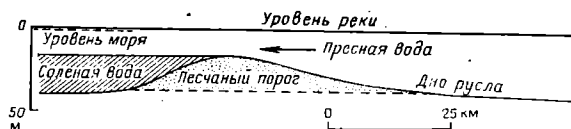
Рис. 56. Схематический разрез вдоль русла дельтовой протоки, показывающий соотношение песчаного порога и клина соленой воды внутри русла, заполненного пресной водой [Moore G. T., 1970]
