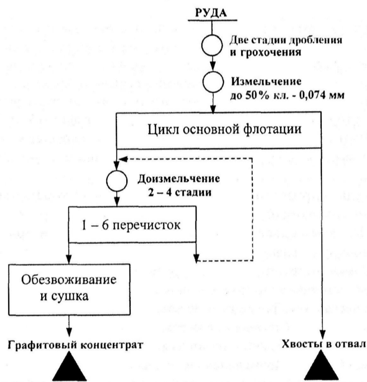
Рис. 24.5. Принципиальная схема обогащения графитовых руд
