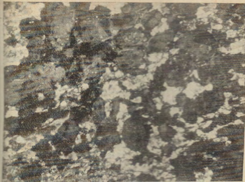
Рис. 16. Фосфорит Хубсугульского месторождения. Доломит (светлое) разоблачает сплошной сгустковый фосфорит (темное) на участки неправильной формы и округлые зерна. Никели полускряшены. Увел. 30.
