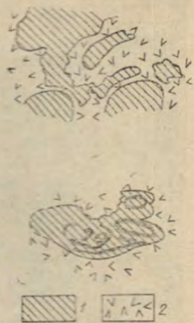
Рис. 6. Зарисовки «галеk» по шлифу из фосфоритового «гравелита» с горы Кучестаиха (см. рис. 5) (1 — фосфат с зонами пигментации, 2 — карбонат). Увел. 25.
