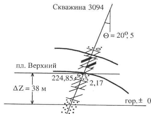
Рис. 2.15. Графическое определение отметки плаstopодсечения на разрезе
