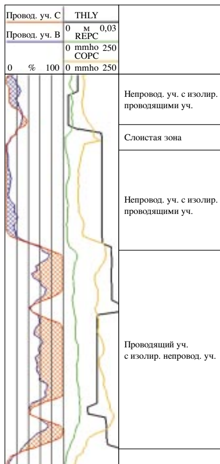
Рис. 15. Использование классификации пористости по Нурми при автоматической обработке данных. Изображение FMI обрабатывается для получения проводящих и непроводящих сегментов (В). Сегменты, которые не выдержаны по всему изображению, отбрасываются (С). Проводящий участок по каждому обработанному изображению наносится как каротажная кривая (синий цвет — В, красный цвет — С). Средние проводимости для непроводящих сегментов в В (зеленый цвет) и для проводящих сегментов в В (оранжевый цвет) показаны с вариацией толщины этих сегментов по ширине изображения (черный цвет).
