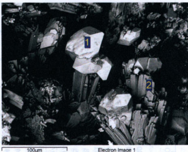
Рис. 47. Нарастание псевдооктаэдрических кристаллов браунита (1) на призмы охотскита (2)
