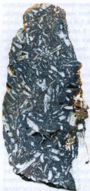
Рис. 27. Брекчиевая псиломелан-гетитовая руда с порфирированными обломками кварцита. Сунгайское месторождение
