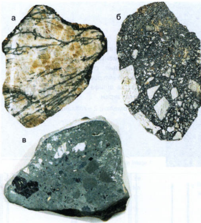
Рис. 14. Брекчиевые марганцевые руды (а, б) и рудокласты (в); иногда брекчиевые руды переходят в сетчатые и прожилковые брекчиевидные образования (а); рудокласты (в) содержат, кроме обломков кварцита, остроугольные и сглаженные обломки марганцевой руды
