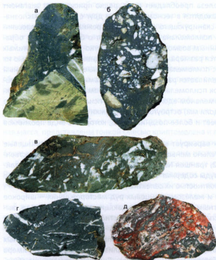
Рис. 26. Марганцевые и железомарганцевые руды: брекчиевые, прожилково-брекчиевые, рудокласты Сунгайского месторождения: а – марганцеворудная брекчия: обломки силицита с реликтами темно-серых углеродистых участков; б – брекчиевая марганцевая руда; в – рудная брекчия (рудокласт) с рудными и кварцевыми обломками, сцементированными псиломелан-гетитовым агрегатом (в верхней части снимка – обломок железомарганцевой руды); г – богатая прожилково-брекчиевая марганцевая руда; д – кварцитобрекчия яшмовидная марганцево-железистая с элементами слоистости. Дурновское месторождение, полированный штаф
